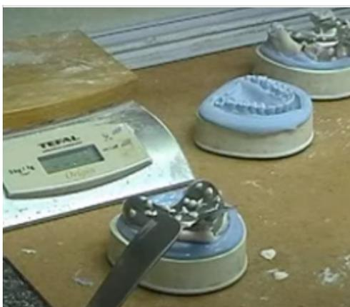
Рис. 5. Снятие формы с вибростола для окончательного застывания
